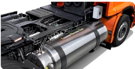
Fig. 4 LNG-tank op chassis
