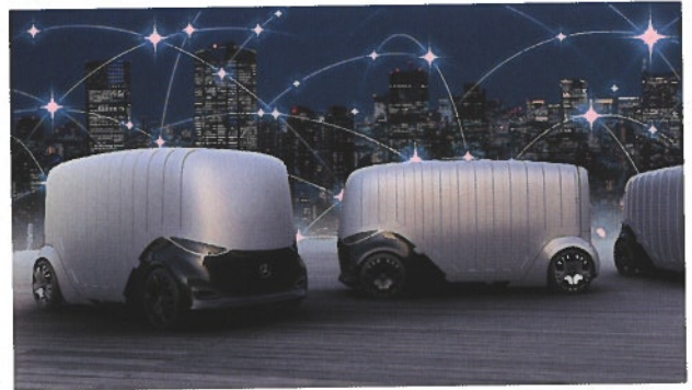
De Urbanetic Cargo van Daimler heeft evenmin een bestuursruimte. Hij kan 10 palletten laden.
