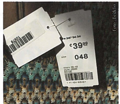
Het systeem bij Bel&Bo voorziet in 'overhead reader' technologie (bv. aangebracht in het plafond) zodat de voorraad continu kan gescand worden en de locatie van het kledingstuk ook gekend is. Uit die geregistreerde data kan afgeleid worden hoeveel maal een stuk naar het pashokje is meegenomen, in welke kleur of maat,...
