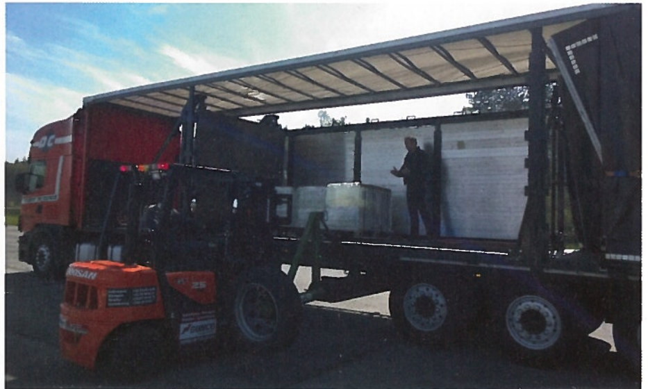
Uit de testen op circuit bleek duidelijk dat schuivende of kantelende pallets sequentieel tegen de wand botsen, waardoor de krachten van de individuele pallets niet eenvoudigweg bij elkaar opgeteld kunnen worden om de maximale kracht te bepalen.
