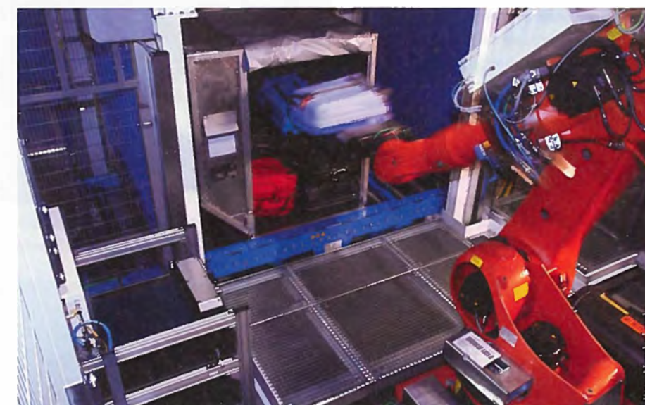
Een collaboratieve robot kan gemakkelijk en snel worden ingeschakeld. De investeringskosten van deze – meestal levensgrote – robots zijn beperkt én ze zijn in staat om perfect met mensen samen te werken, zonder fysieke afscherming.
